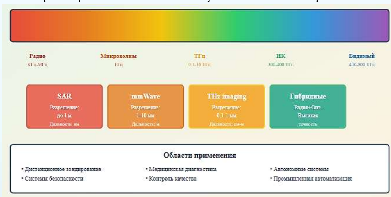
Рис. 1 – Классификация технологий радиовизуализации по диапазонам частот
