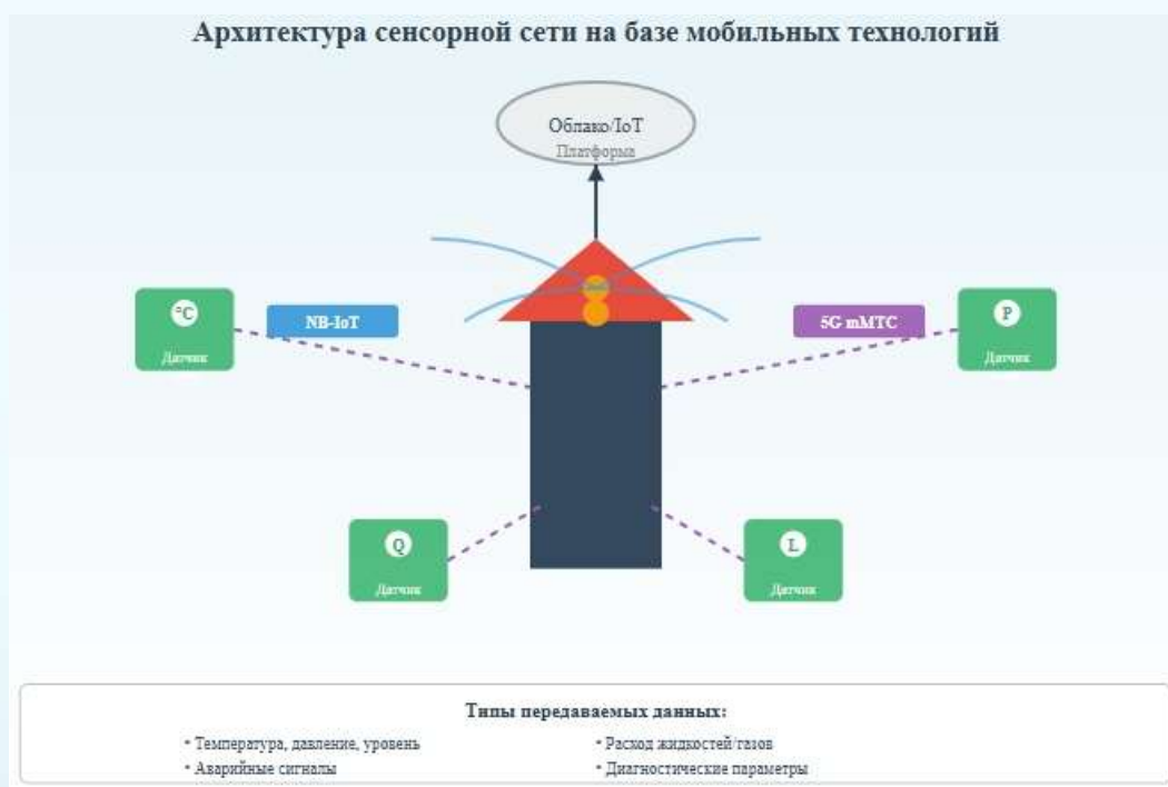
Рис. 2 – Архитектура беспроводной сенсорной сети с использованием технологий мобильной связи
